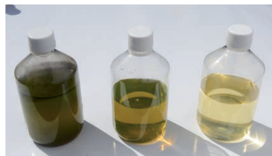
Liquide de refroidissement avant et après traitement
